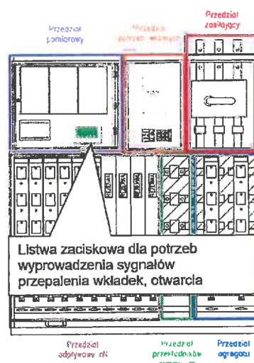
Rozdzielnica nN wewnątrz
